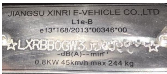
Ilustración 8: Ejemplo placa de fabricante ciclomotor de vehículo homologado posterior al 1 de enero de 2016
