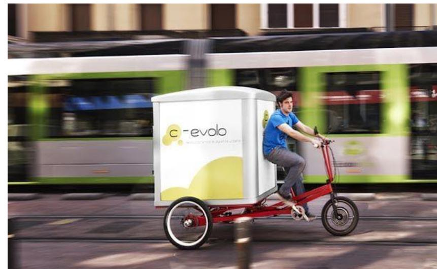
**No son vehículos de movilidad personal porque además de ser auxiliados al pedaleo mediante un motor eléctrico de hasta 250 W, el motor se detiene si no se emplea la fuerza muscular del conductor.**
