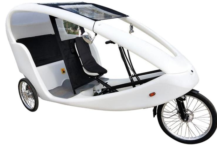
**No son vehículos de movilidad personal porque además de ser auxiliados al pedaleo mediante un motor eléctrico de hasta 250 W, el motor se detiene si no se emplea la fuerza muscular del conductor.**
