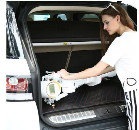
El modelo LEHE, que aparece en las fotografías, pesa apenas 18 kg, alcanza una velocidad de 30 km/h, es plegable, tiene una autonomía de 35 km y el tiempo de carga de sus baterías es de 3 a 4 horas.
