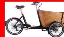
**Este tipo de vehículos son ciclos** si no tienen ningún tipo de ayuda al esfuerzo muscular del conductor, o si, como suele ser habitual, sólo disponen de un motor auxiliar con un máximo de 250 W de potencia. Si sobrepasan esa potencia pasan a ser ciclos de motor, de acuerdo con las definiciones que figuran en el Anexo II. A RGV).
