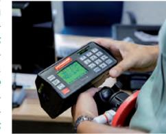
Los resultados de la prueba de frenada, nos explica, dependen "de la velocidad a la que hacemos la prueba, la distancia de frenado en esa prueba y el tiempo de frenado. En función de esos tres parámetros, obtenemos la deceleración que ha tenido el vehículo y, también, el coeficiente de rozamiento entre el neumático y la vía, un dato que utilizaremos para los cálculos físicos y para su introducción en el escenario donde se ha hecho la prueba".
